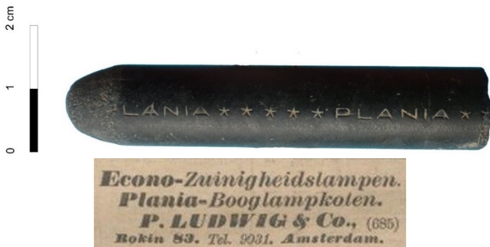
Afbeelding 2: Koolspits van het fabricaat Plania uit de eerste decennia van de 20 ste eeuw en een advertentie voor Plania-booglampen (bron: Het Vaderland, 18 januari 1911)
