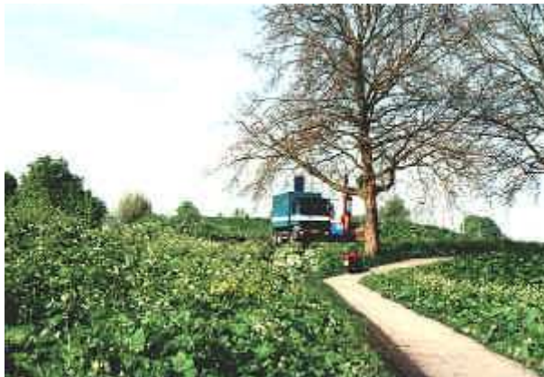
Afb. 1. Mechanische sondering op bastion V te Gorinchem
